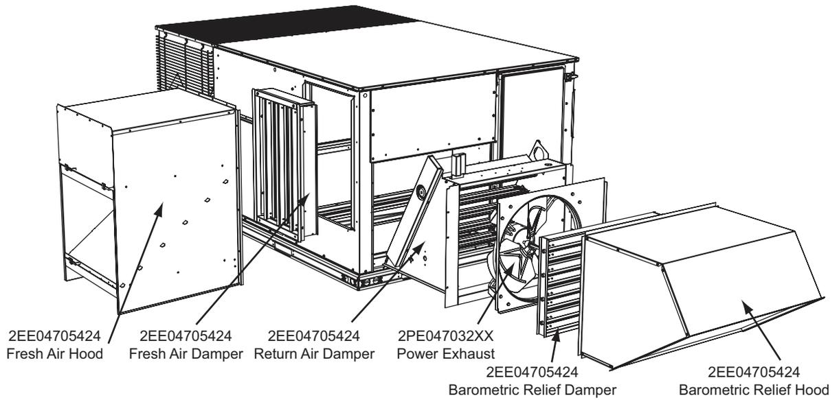
**FIGURE 12 - FIELD INSTALLED DOWNFLOW ECONOMIZER W/POWER EXHAUST**
