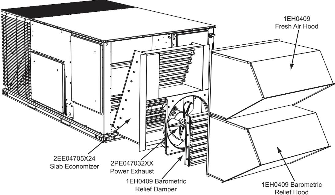
**FIGURE 14 - SLAB ECONOMIZER DOWNFLOW W/POWER EXHAUST**
