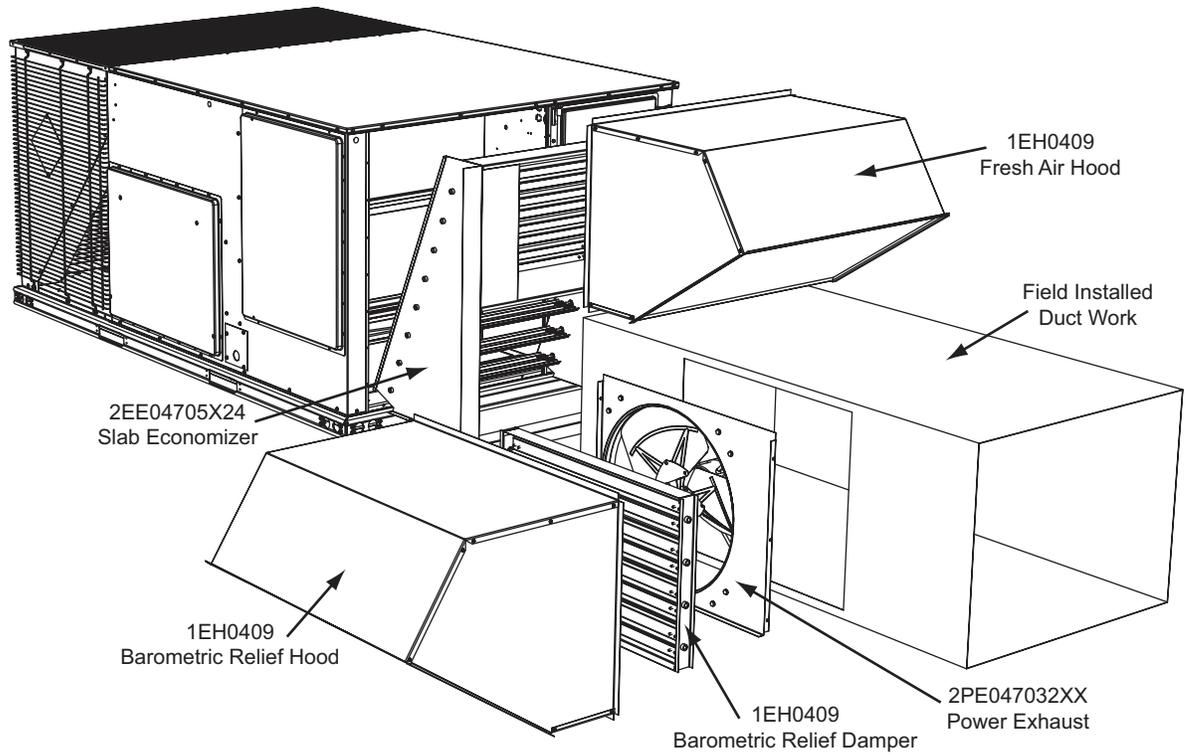
**FIGURE 15 - SLAB ECONOMIZER END RETURN W/POWER EXHAUST**
